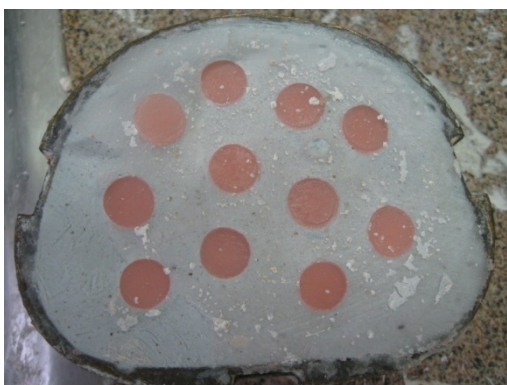
Slika 1. Polimerizacija uzoraka topopolimerizovanog akrilata u standardnoj metalnoj kiveri (Changsha Zhongbang Medical Instruments Co., China)
