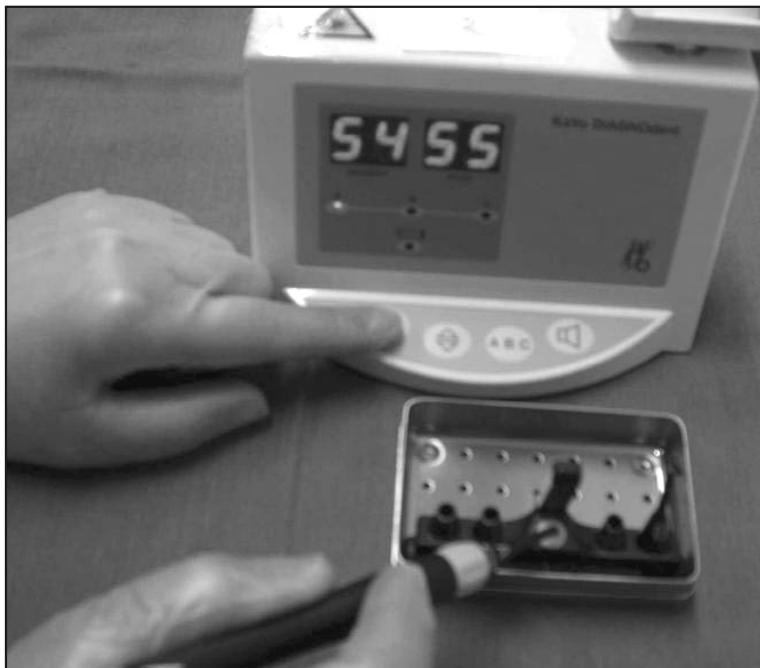
Slika 2. Kalibracija. U kalibracione svrhe kasete uključuje standard poznatog i stabilnog fluorescentnog polja radi kompenzacije potencijalne varijacije sistema. Sonda se drži naspram keramičkog standarda sa preregistrovanom vrednošću. Displej mora da se poklapa sa standardnim vrednostima uz toleranciju od \pm 3
