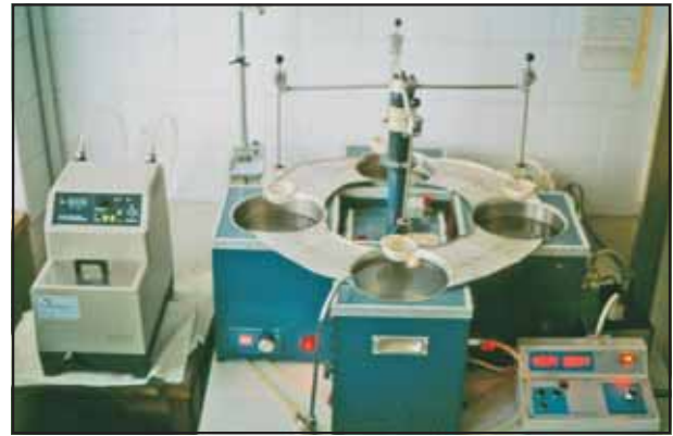
Slika 1. Oprema za termocikluse sa vodenim kupatilima Figure 1. Thermocycling device
