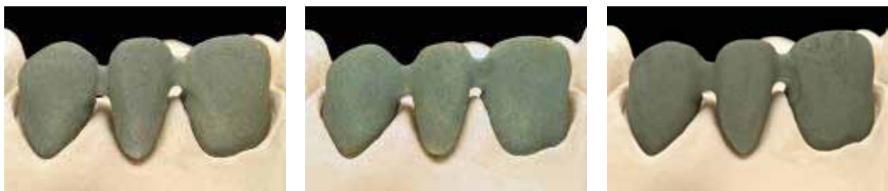
Sl. 8. a-c Legure nakon oksidacije Fig. 8. a-c Alloys after oxide firing
