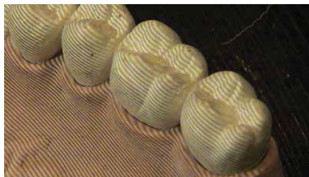
Slika 4. Projekcija svetla prilikom skeniranja Figure 4. Light projection during scanning
