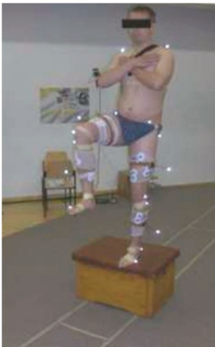
Slika 5. Ispitanik opremljen oznakama za kinematičko merenje, elektrodama i ostalom opremom za telemetrijsko površinsko EMG merenje, spreman za izvođenje testa saskok na mernu platformu.
